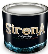
E' una speciale antivegetativa con effetto autopulente a base di ossido di rame e composti antialga e antilimo non inquinanti. I copolimeri sintetici con cui è composto il legante conferiscono al prodotto una solubilità controllata nel tempo. Con spessori di 120 microns di film secco la durata può variare da un minimo di 12 ad un massimo di 16 mesi. Si applica su scafi in ferro, vetroresina e legno con velocità sino a 20-25 nodi circa.
